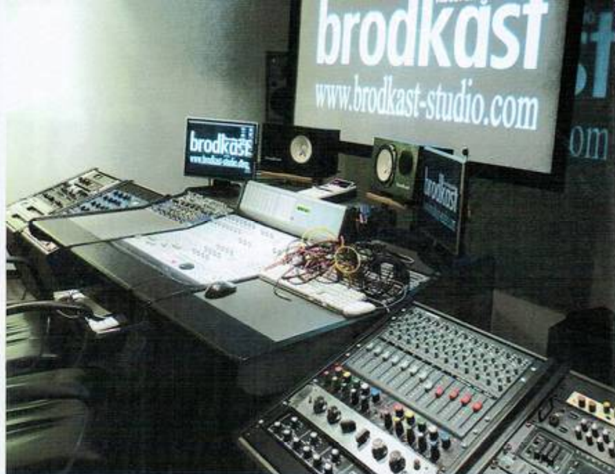
La cabine A de Brodkast, vue du côté droit. Dans les racks : SSL X-Panda, GML 8200, Pultec Program EQH2, Moog 3 band parametric EQ, ensoniq DP4+, Eventide H969, Lexicon PCM60, Yamaha SPX-90II, Yamaha D1500 x 2, Ensoniq DP2.
